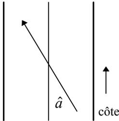
Je monte à bicyclette une côte à 8% ( élévation de 8 m pour 100 m sur le plat) sur une route bien droite. Sous quel angle  $\hat{a}$  par rapport à l'axe de la route dois-je choisir ma trajectoire afin de ne plus monter cette côte qu'à 5% ?
