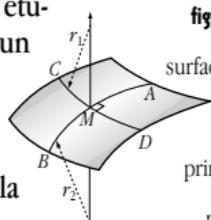
**figure 1.** La courbure moyenne de la surface est définie par l'intermédiaire de deux rayons appelés rayons principaux, qui sont dans des plans perpendiculaires.
